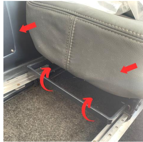
Figura 4 – Indicação da alavanca e movimentação do banco
