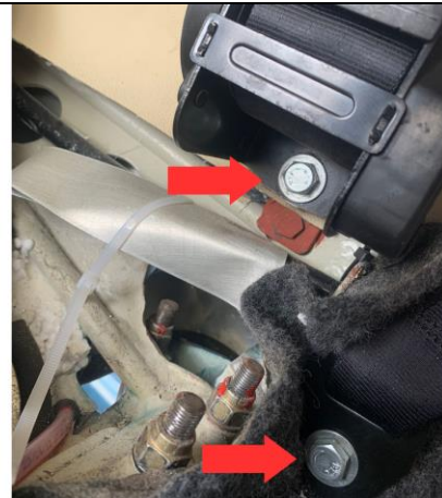
Figura 6 – Fotos dos pontos aos quais devem ser desacoplados Figure 6 - Photos of the points where they should be disconnected
