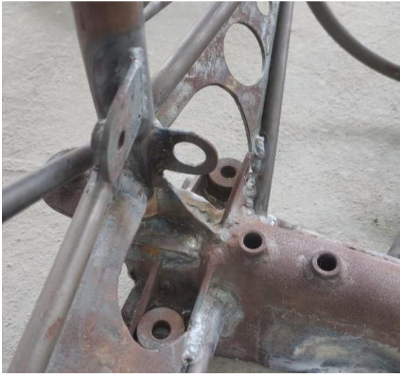
Figura 5 – Adição do reforço estrutural chamado “mão francesa” no ponto de rachadura Figure 5 - Addition of the structural reinforcement called "French hand" at the cracking point
