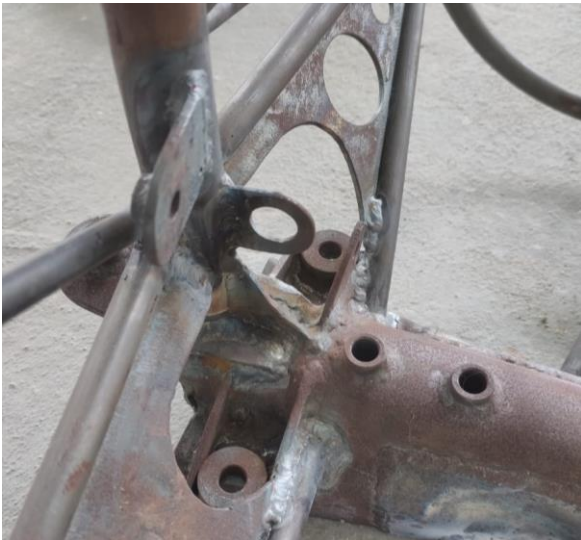
Figura 5 – Adição do reforço estrutural chamado “mão francesa” no ponto de rachadura
