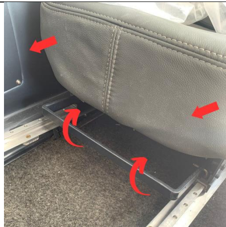
Figura 4 – Indicação da alavanca e movimentação do banco Figure 4 - Instruction for lever location and seat movement
