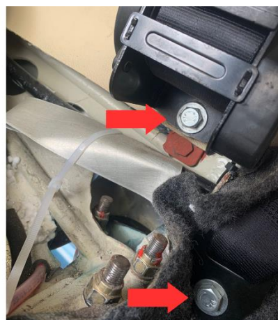
Figura 6 – Fotos dos pontos aos quais devem ser desacoplados Figure 6 - Photos of the points where they should be disconnected
