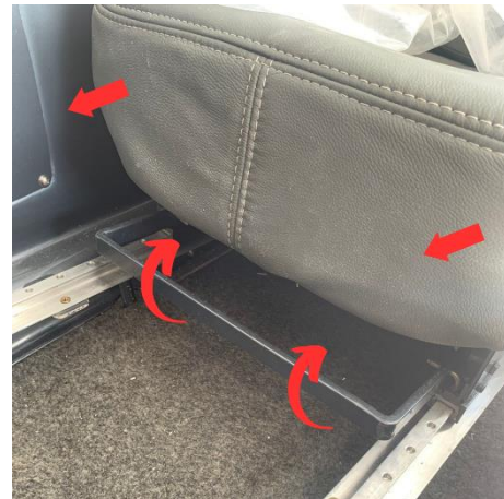
Figura 4 – Indicação da alavanca e movimentação do banco
