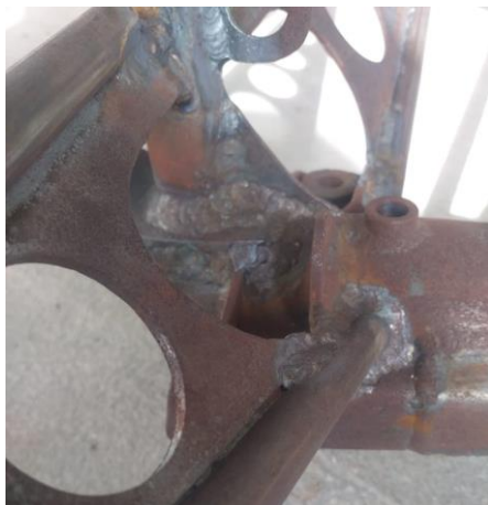
Figura 1 – Trincas no tubo de aço 4130 localizado no trem de pouso principal
